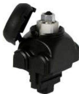
برای هادی های عایق شده آلمینیوم و مس استفاده می شود. پیچ تعییه شده بر روی کانکتور عایق است. ارتباط کانکتور با هادی اصلی و انشعاب با عملکرد پیچ ایجاد می گردد. این کانکتور قابلیت نصب بر روی خطوط حامل جریان (Hot Line) را بدون برداشتن عایق هادی ها دارد.
