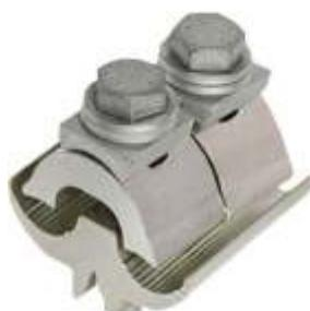
برای اتصال کابل آلمینیوم به آلمینیوم در مقاطعی از شبکه کابل خودنگهدار که کشش های مکانیکی را شامل نشود کاربرد دارد. گشتاور ترکمتر توصیه شده برای ارتباط دو طرفه بسیار ضروری است. بدنه ای کانکتور از جنس آلمینیوم مقاوم به خوردگی با رسانایی بالا و مقاومت الکتریکی کم ساخته شده است.
