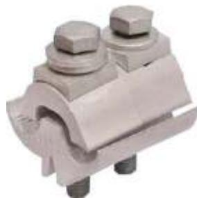
برای اتصال کابل آلمینیوم به آلمینیوم در مقاطعی از شبکه که کشش های مکانیکی را شامل نشود کاربرد دارد. گشتاور ترکمتر توصیه شده برای ارتباط دو طرفه بسیار ضروری است. بدنه ای کانکتور از جنس آلمینیوم مقاوم به خوردگی با رسانایی بالا و مقاومت الکتریکی کم ساخته شده است.
